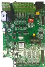
Рисунок 9.5 – Плата управления с покрытием лаком
