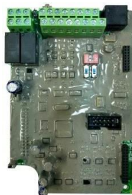
Рисунок 9.4 – Плата управления с покрытием компаундом
